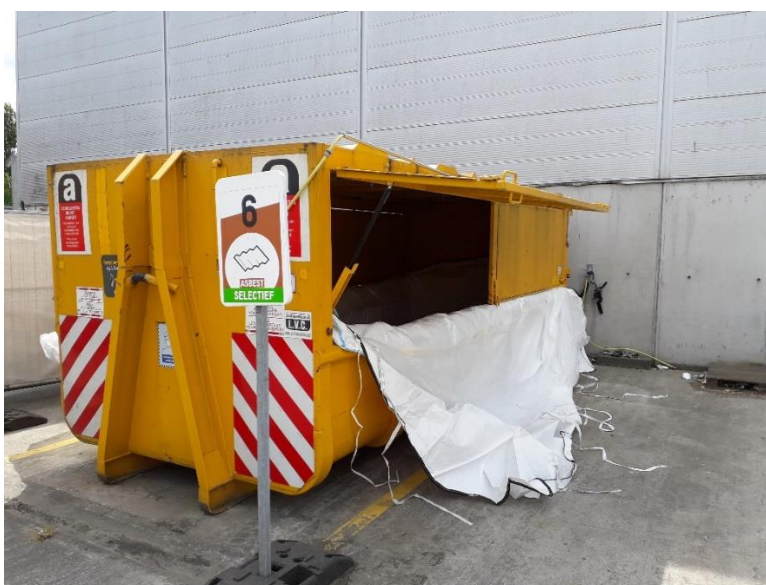
Figuur 15: de nieuwe asbestcontainer.
