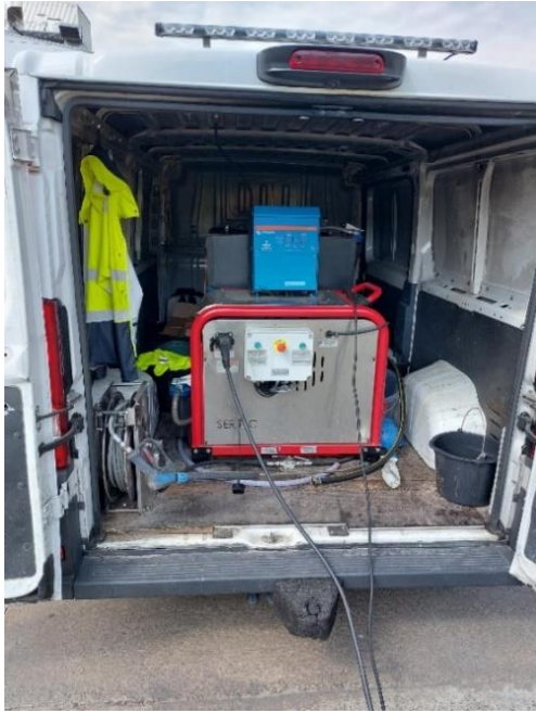
Figuur 63: Elektrisch aangedreven hogedrukinstallatie
