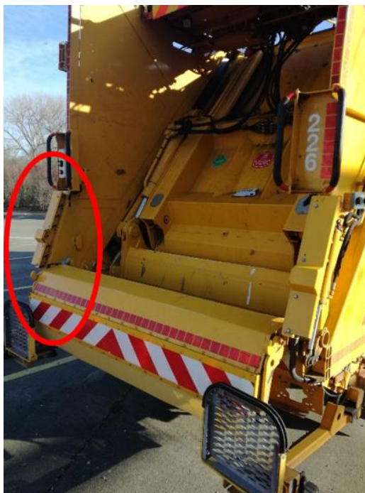
Figuur 57: een voertuig voor de ophaling van papier en karton, voorzien van een lichtgordijn.
